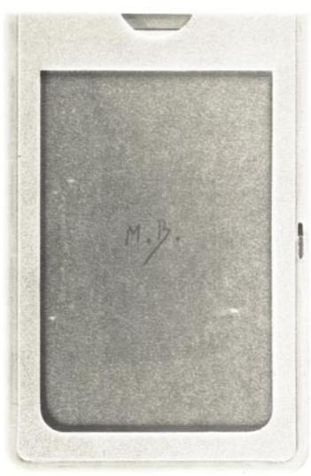
Die Schreibtafel beruht auf dem folgenden Prinzip: jede Beschriftung wird durch einfaches Herausziehen der Tafel ausgelöscht. Sie bleibt aber unsichtbar auf einem Film im Innern der Vorrichtung graviert.
